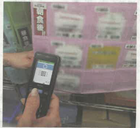
服薬支援システム「nondi」 一包化した薬包のバーコードを読み取り誤薬を防ぐ
